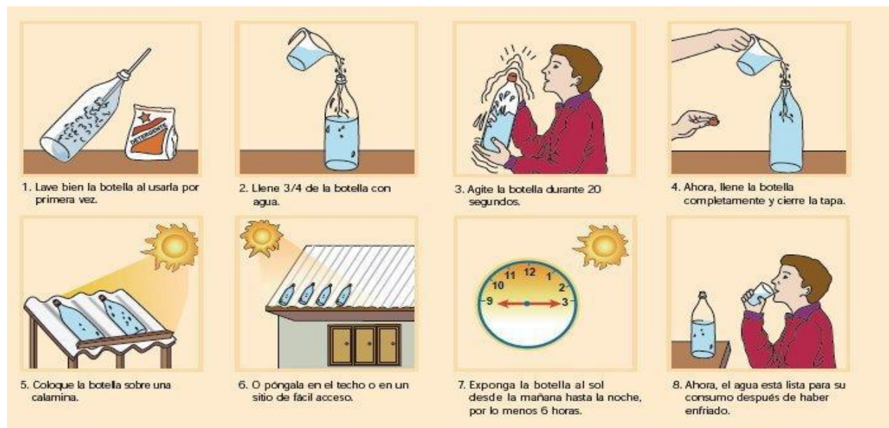
Figura 2 Principio del método SODIS
