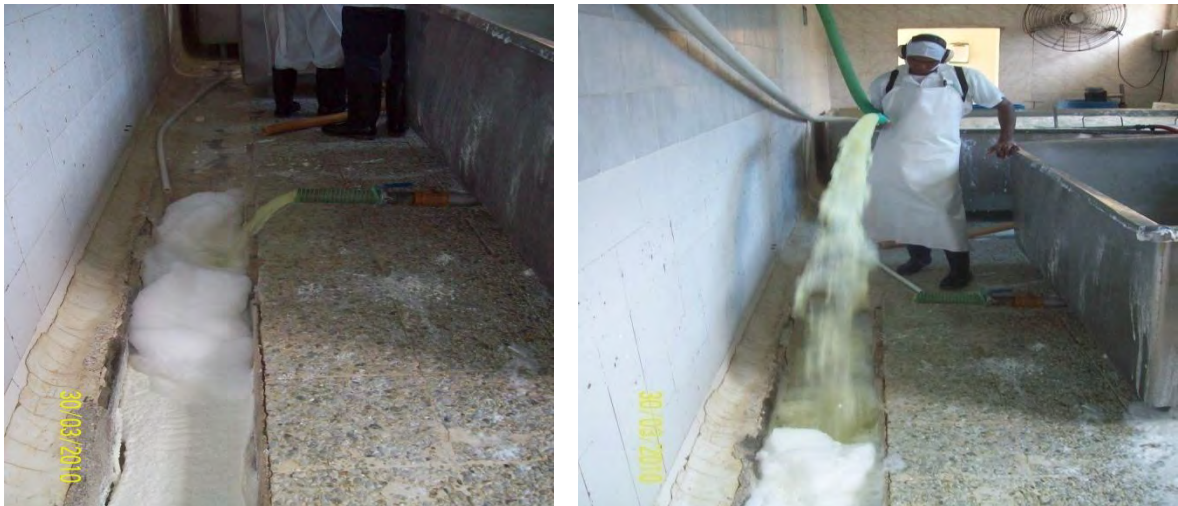
Figura 6. Vertimiento de lactosuero al alcantarillado
