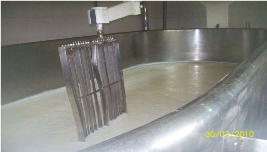
Figura 28. Tina polivalente, pasteurización lenta
