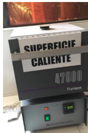
Ilustración 13. Muestra en la mufla
