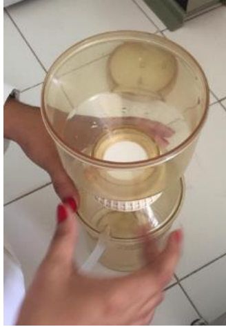
Ilustración 16. Lavado y enjuague de filtros
