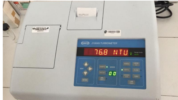
Ilustración 6. Muestras para determinar turbiedad inicial
