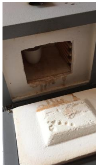
Ilustración 13. Muestra en la mufla
