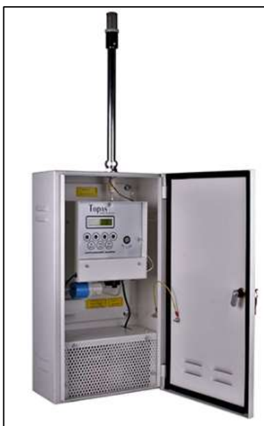
Figura 3. Ilustración de un muestreador de PM2.5 sistema TOPAS.
