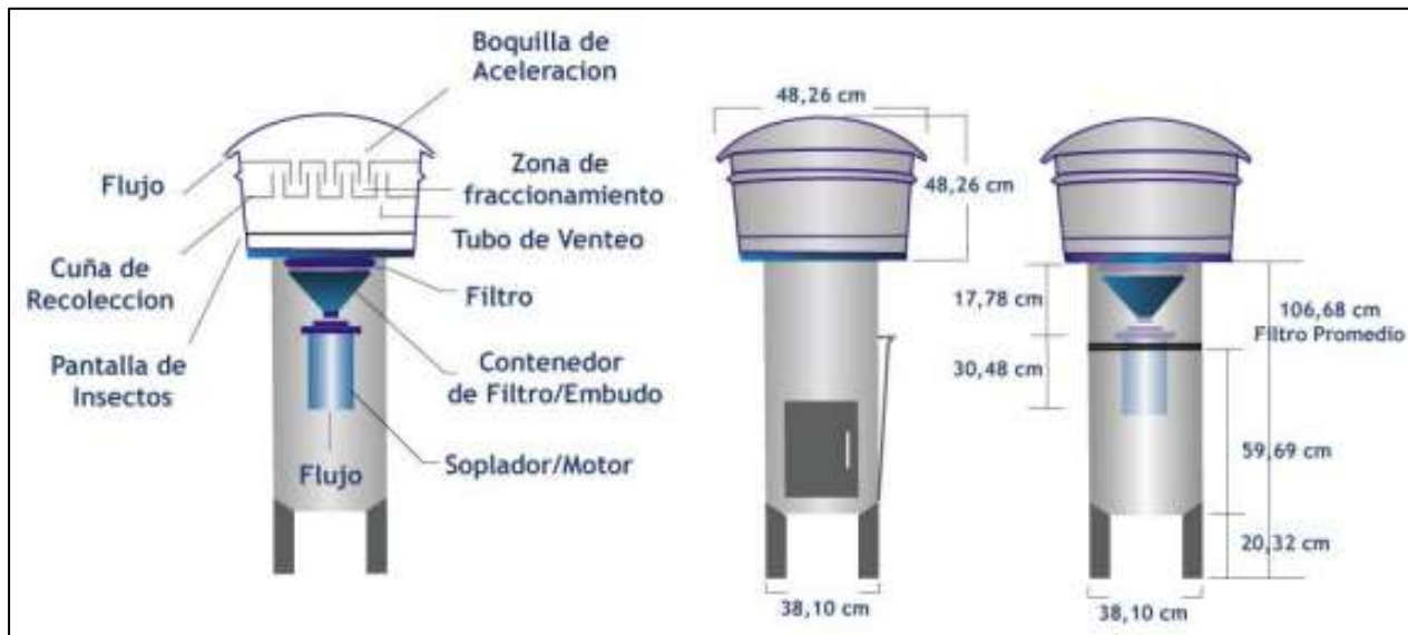
Figura 2. Ilustración de un muestreador de PM10 – PM2.5 para HI-VOL.
