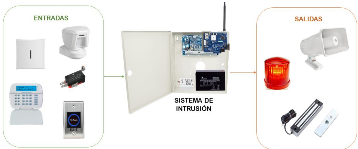
Figura 1. Esquema del sistema de detección de intrusos. Fuente: propia.
