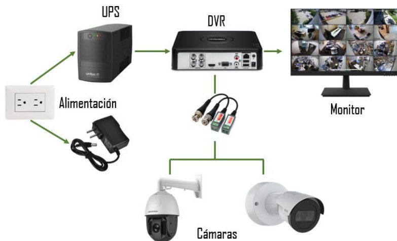
Figura 10. Diagrama CCTV analógico. Fuente: propia.
