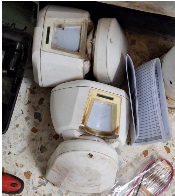
Figura 62. Sensores PG9994 retirados por falla. Fuente: propia.
