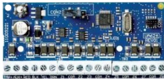
Figura 6. Expansor de zonas para panel de alarma. Fuente: propia.
