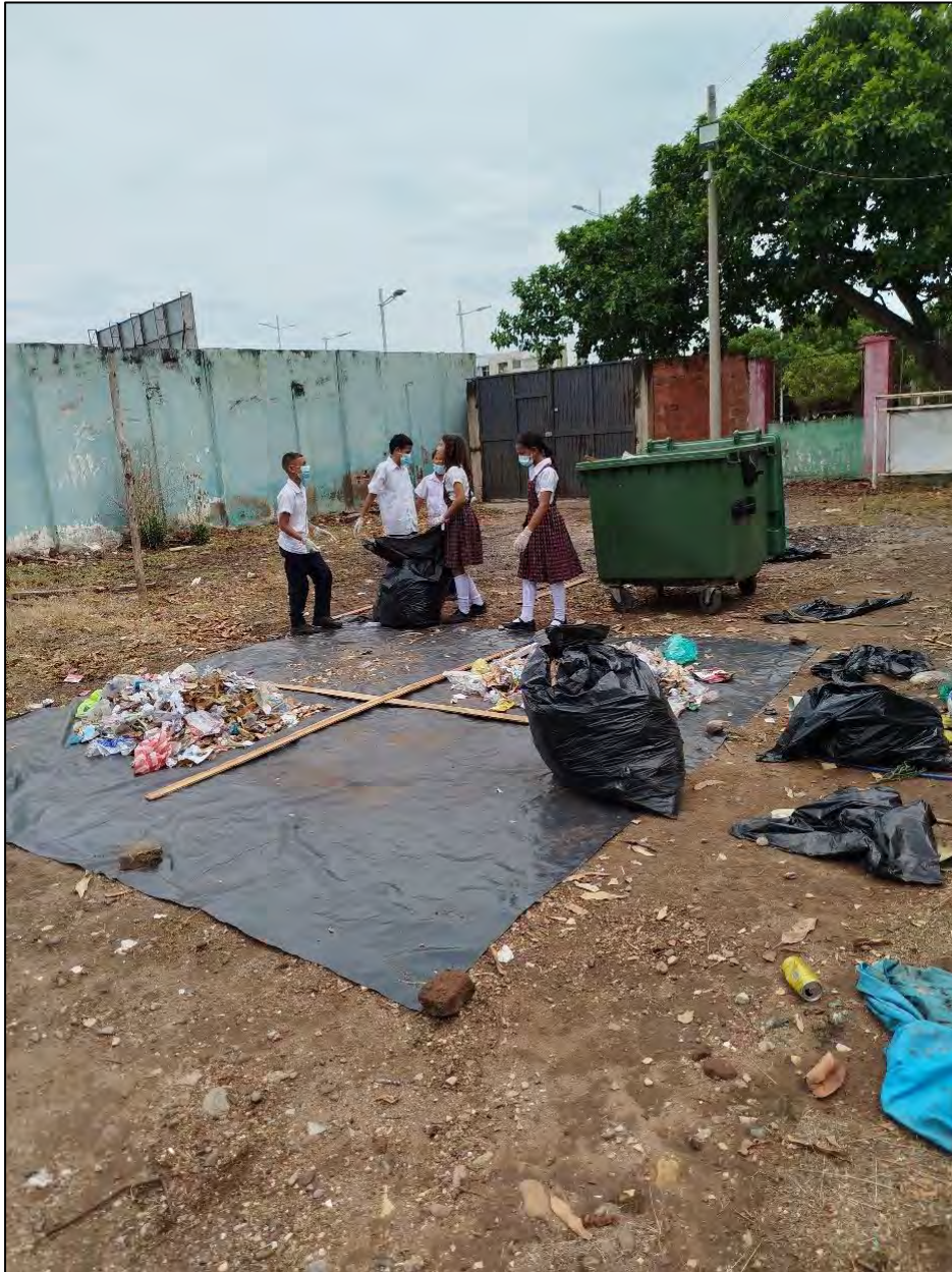
Imagen 13. Método del cuarteo para residuos sólidos aplicado en la Institución Educativa Ciro Pupo Martínez
