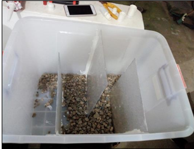
Fotografía 2 Humedal artificial de flujo subsuperficial horizontal con pantallas
