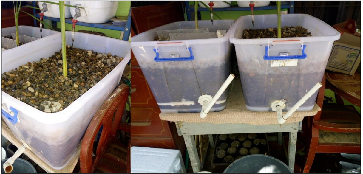
C Humedal artificial con pantallas (Izquierdo) y Humedal convencional (Derecha)
