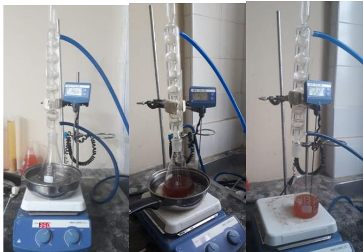
Ilustración 10. Montaje para la obtención del biodiésel
