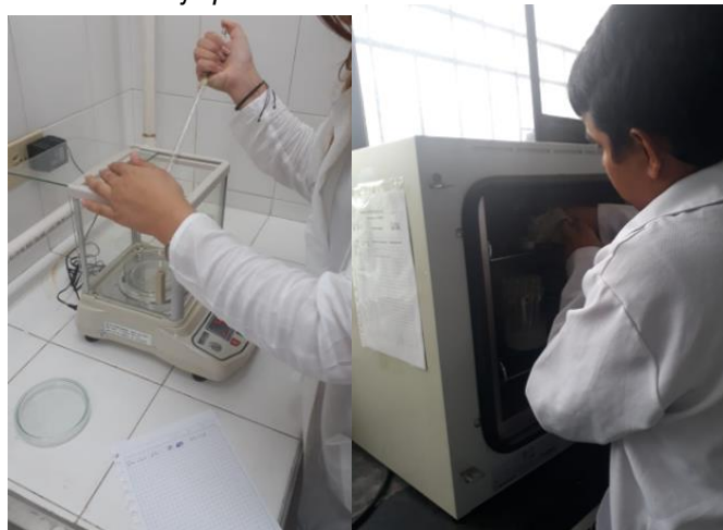
Ilustración 14. Montaje para la determinación de humedad del biodiésel
