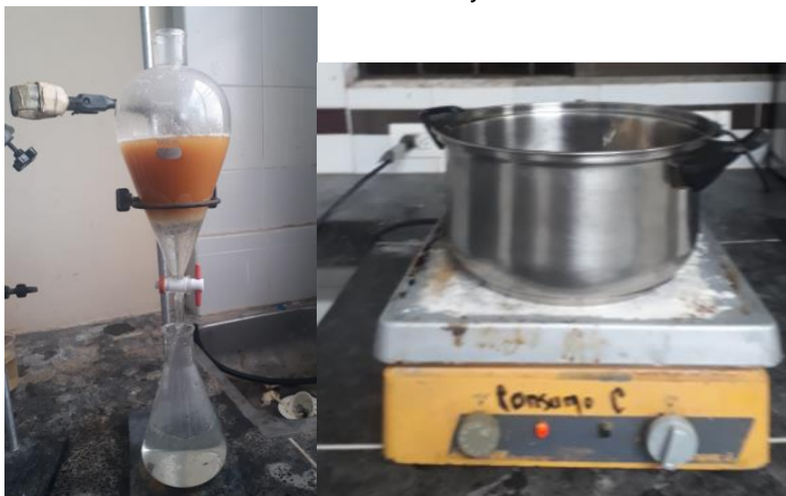
Ilustración 5. Proceso de lavado y secado del aceite
