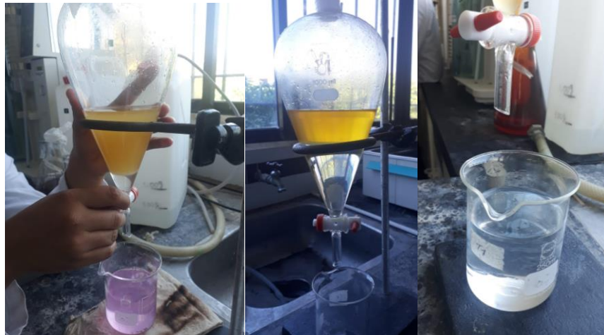
Ilustración 12. Lavado de biodiesel
