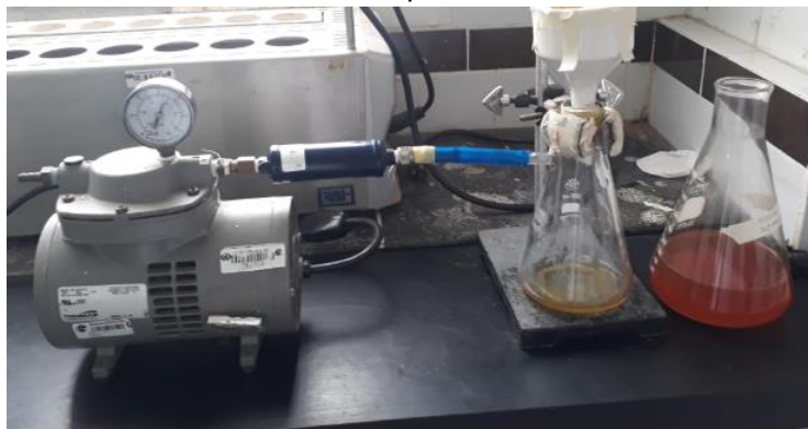
Ilustración 6. Filtración del aceite por medio de una bomba de vacío
