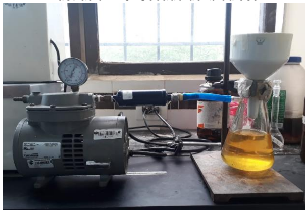
Ilustración 13. Secado del biodiesel
