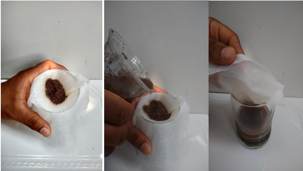
ANEXO 12. Vertimiento de solución extractora en el suelo para ser filtrada
