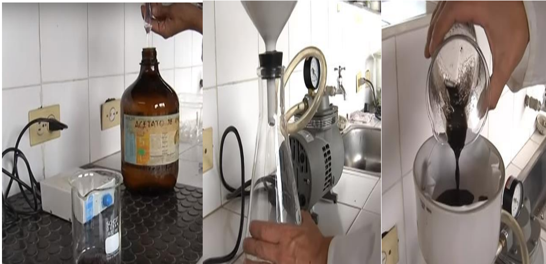
ANEXO 12. Vertimiento de solución extractora en el suelo para ser filtrada
