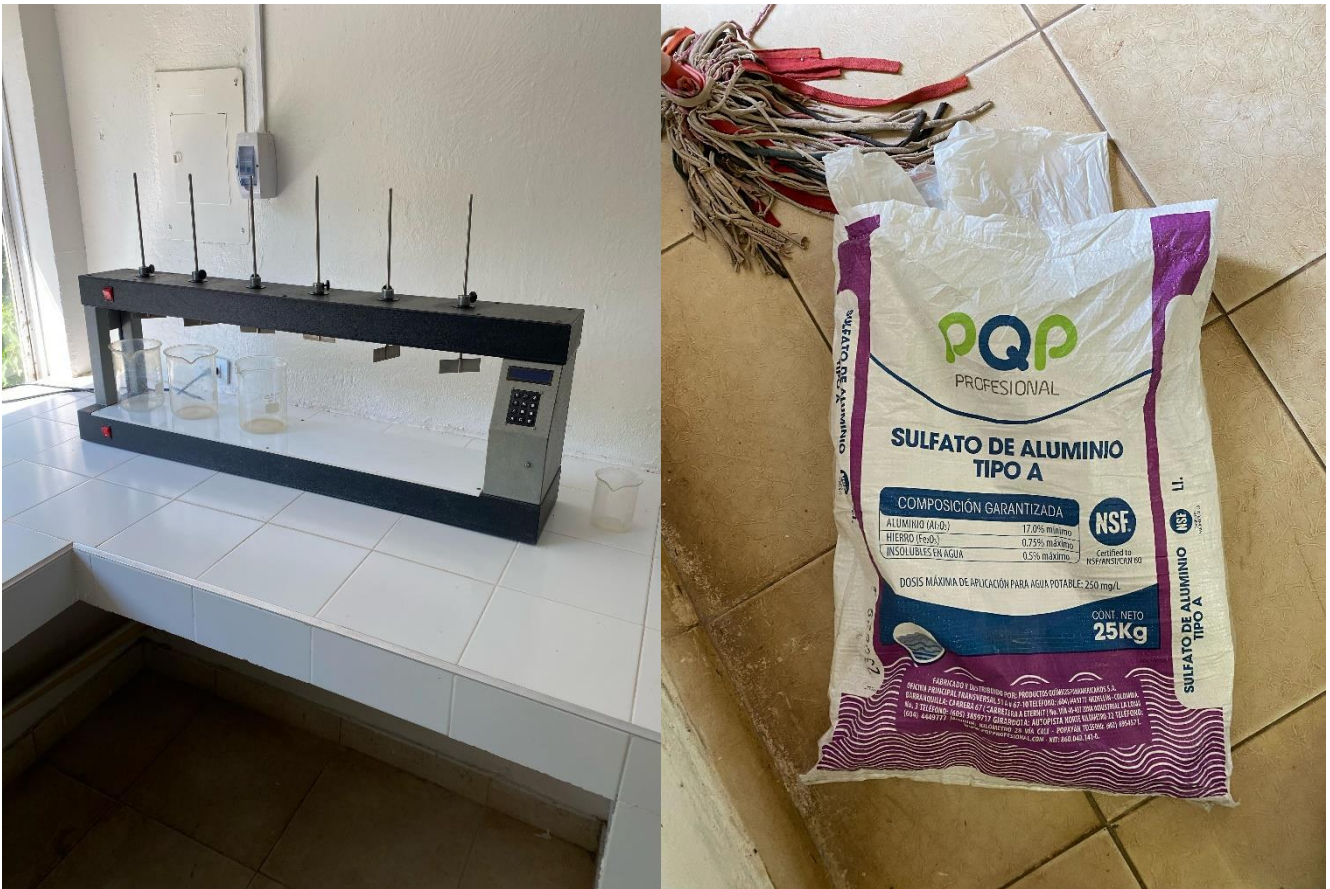
Figura 16. Montaje para ensayo de prueba de jarras
