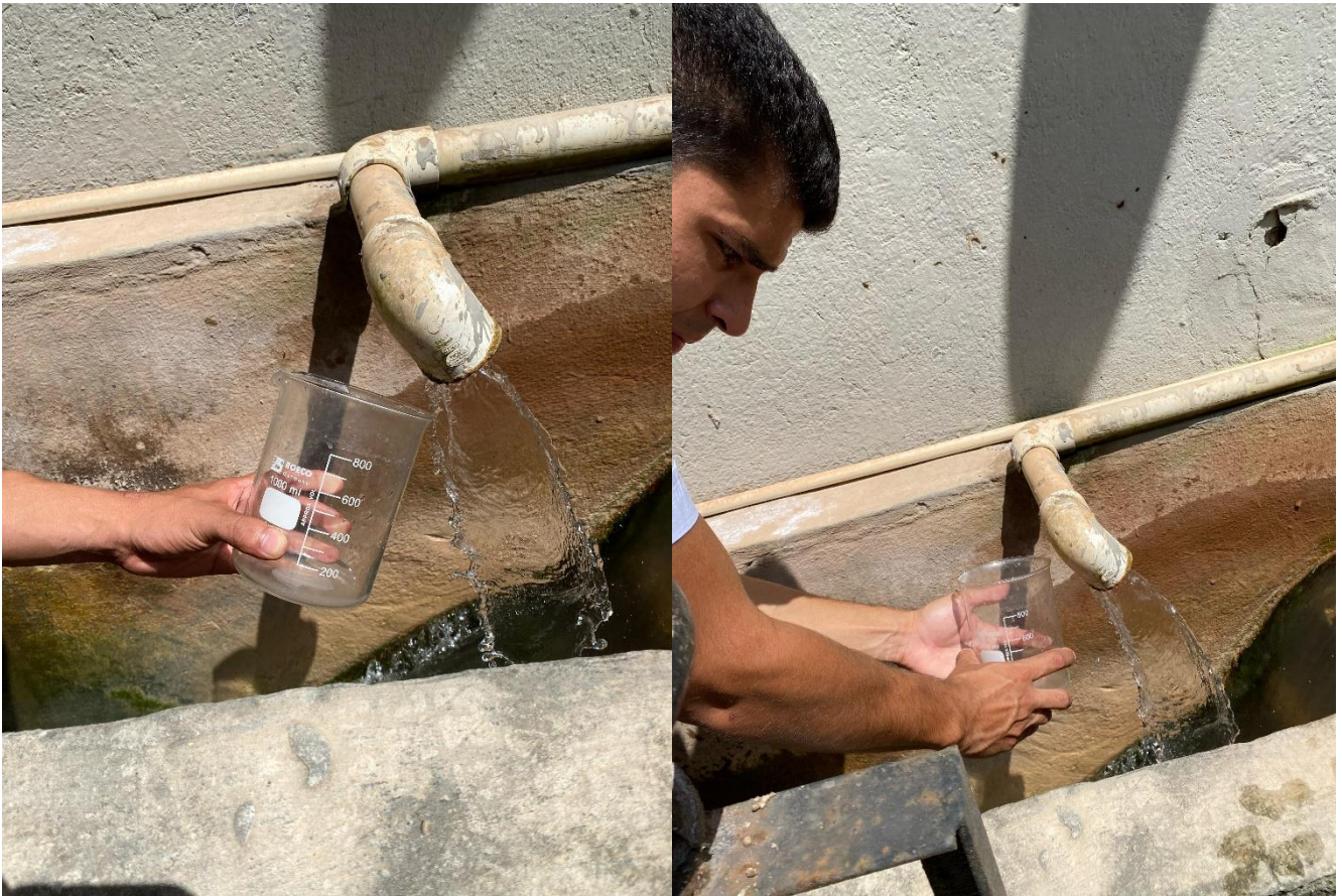
Figura 13. Mediciones del caudal que sale por el tubo dosificador.
