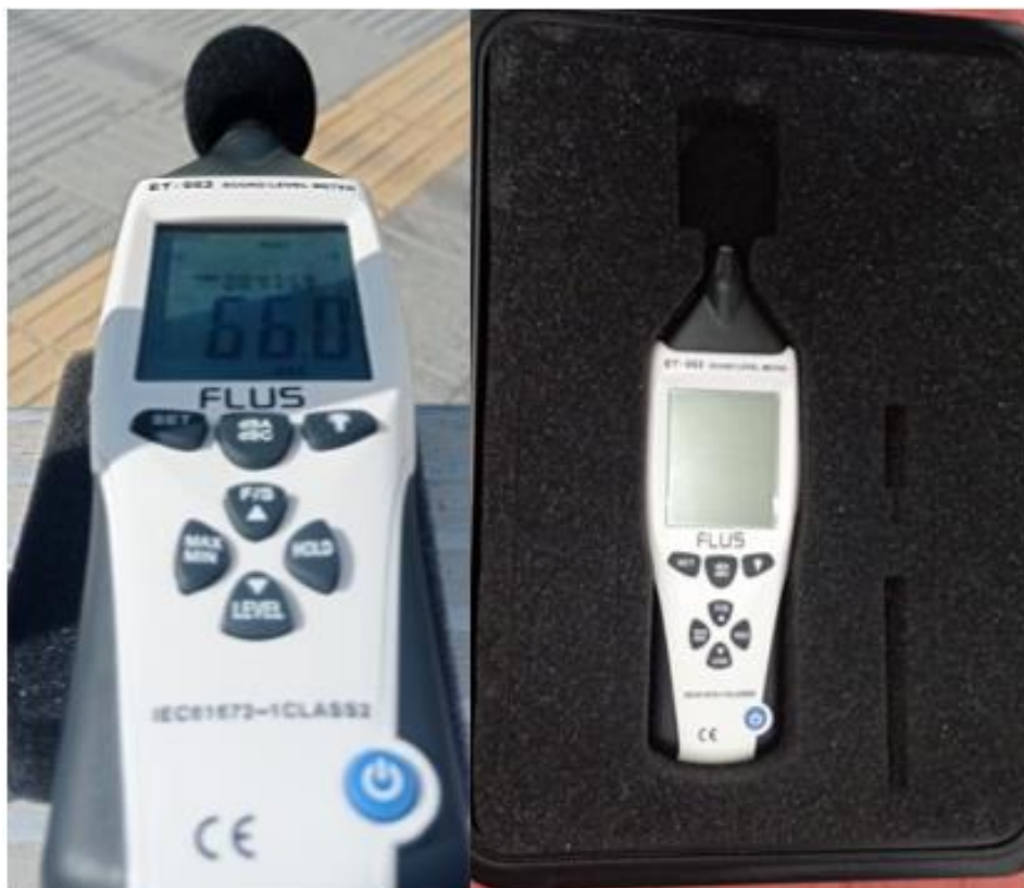
Ilustración 15: Sonómetro Tipo 2 Flus ET 953
