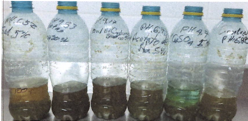
Figura No. 1. Pruebas de cambio de color por pardeamiento, en mezcla empleada para elaborar papel a base de taruya.
