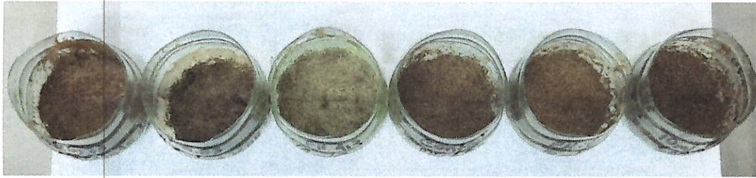
Figura No. 2. Cambio del color de la mezcla para hacer papel de taruya, en distintos pH.
