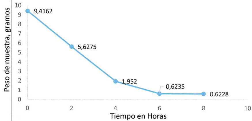
Gráfico 2. Peso de la muestra en función del tiempo del papel taruya, secado a 45 °C.
