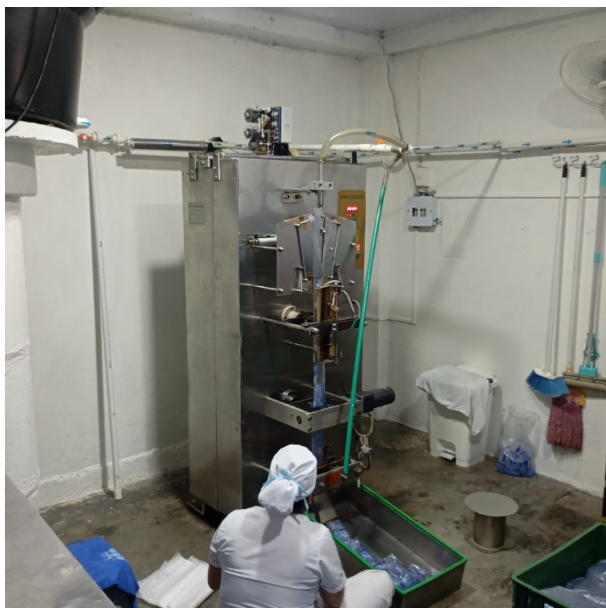
Fuente: elaboración propia – máquina empacadora de bolsa de 320ml en funcionamiento.
