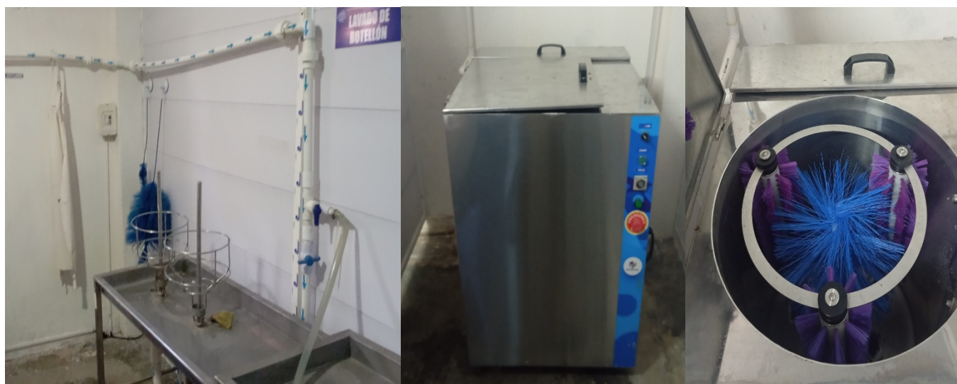
Fuente: elaboración propia - antes y después de condiciones de lavado de botellones de 20L
