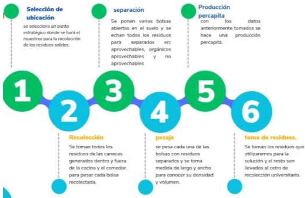
Figura 4. Esquema para separación de RSO por el método de cuarteo
