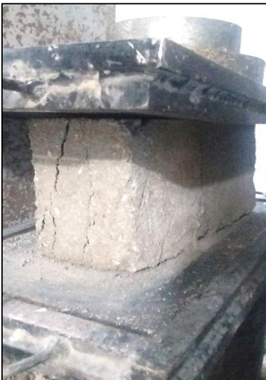
Fotografía 13. Rotura de Ladrillo Ecológico
