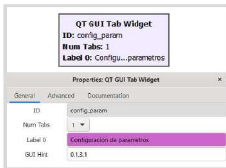
Figura 171. Bloque QT GUI Tab Widget para sección de configuración de configuración de parámetros en 4QAM en GNU Radio en un entorno simulado. Fuente propia
