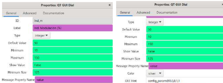
Figura 48. Configuración del bloque QT GUI Dial para la variación del índice de modulación en AM en GNU Radio. Fuente propia.
