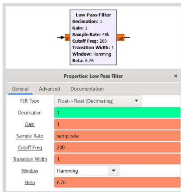
Figura 67. Bloque Low Pass Filter y su configuración para AM en GNU Radio. Fuente Propia.
