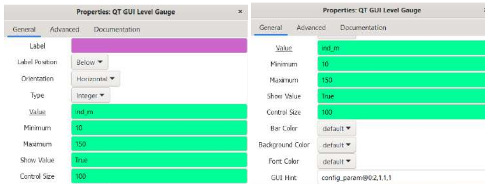
Figura 49. Configuración del bloque QT GUI Level Gauge para la variación del índice de modulación en AM en GNU Radio. Fuente propia.
