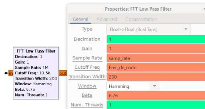
Figura 87. Filtro FTT Low Pass Filter y su configuración para FM en GNU Radio. Fuente propia.
