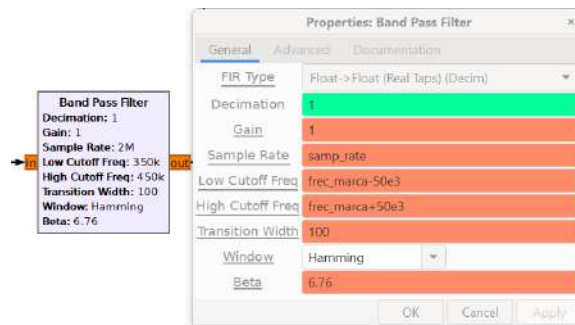
Figura 142. Bloque Band Pass Filter y configuración. Fuente propia.
