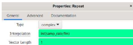
Figura 169. Configuración de los bloques Repeat para 4QAM en GNU Radio en un entorno simulado. Fuente propia
