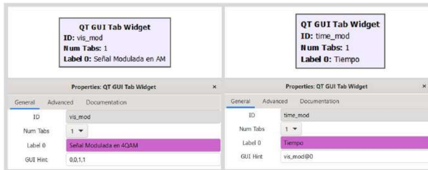
Figura 191. Bloques QT GUI Tab Widget y su configuración para visualización de señal modulada en 4QAM en GNU Radio en un entorno simulado. Fuente propia
