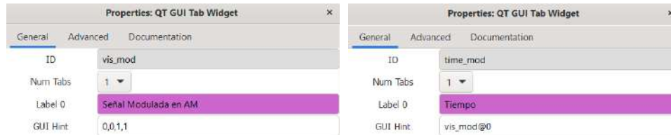
Figura 121. Configuración de bloques QT GUI Tab Widget para visualización de señal modulada en OOK en GNU Radio en un entorno simulado. Fuente propia.
