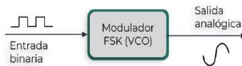
Figura 13. Esquema simplificado de un modulador FSK. Fuente: Basado en Tomasi, 2003.
