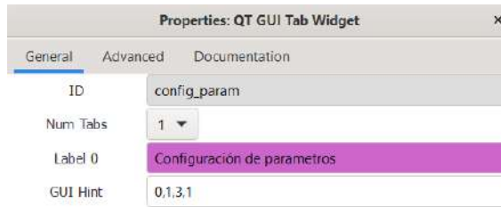
Figura 59. Configuración bloque QT GUI Tab Widget para la sección de configuración de parámetros de modulación en GNU Radio. Fuente propia
