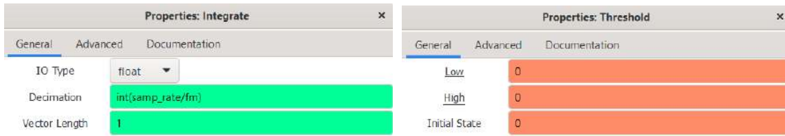
Figura 188. Configuración de los bloques Integrate y Threshold para demodulación de señal 4QAM en GNU Radio en un entorno simulado. Fuente propia
