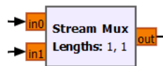
Figura 189. Bloque Stream Mux para demodulación de señal 4QAM en GNU Radio en un entorno simulado. Fuente propia
