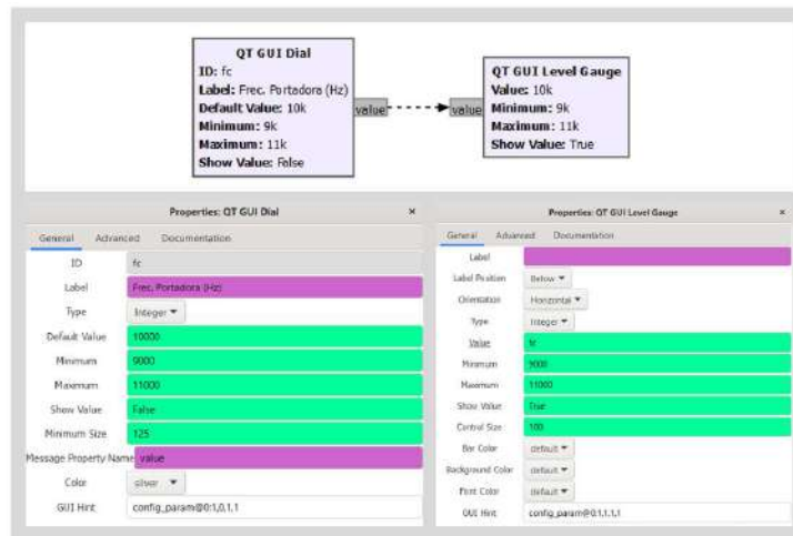
Figura 46. Bloques QT GUI Dial y QT GUI Level Gauge y sus configuraciones para la variación y visualización de la frecuencia de portadora para AM en GNU Radio en un entorno simulado. Fuente propia.
