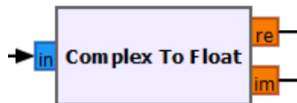
Figura 185. bloque Complex To Float para demodulación 4QAM en GNU Radio en un entorno simulado. Fuente propia
