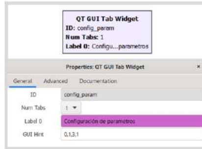
Figura 100. Bloque QT GUI Tab Widget y su configuración para la sección de configuración de parámetros en OOK en GNU Radio en un entorno simulado. Fuente propia.
