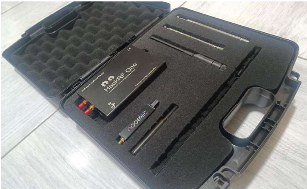
Figura 222. Vista del Entrenador de Radio Definido por Software con hardware SDR integrado en maletín portátil. Fuente propia
