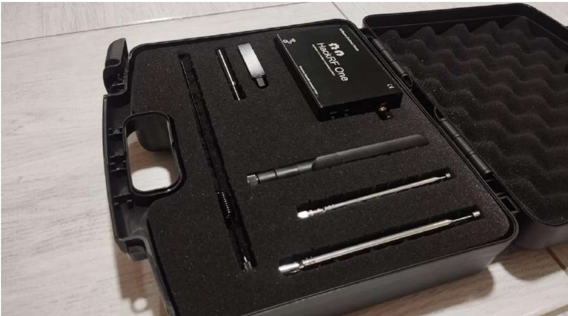
Figura 223. Vista del Entrenador de Radio Definido por Software con hardware SDR integrado en maletín portátil. Fuente propia
