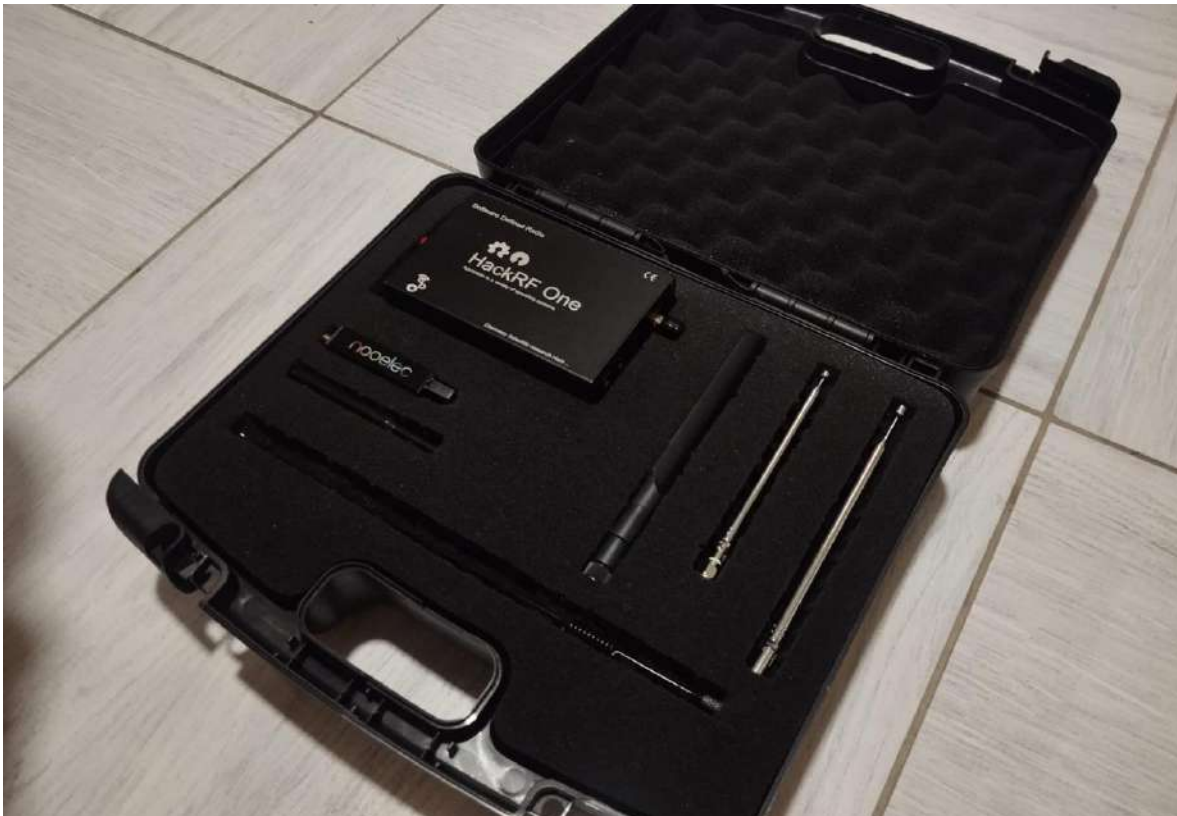
Figura 224. Vista del Entrenador de Radio Definido por Software con hardware SDR integrado en maletín portátil. Fuente propia
