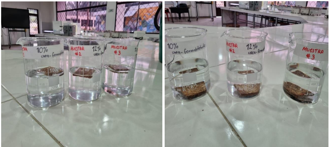
Ilustración 9; Absorción de agua durante 2 horas
