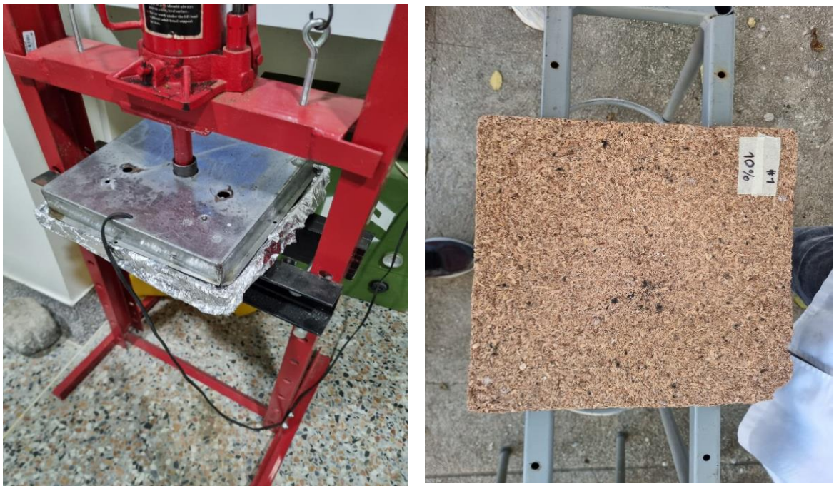
Ilustración 6; Prensado y elaboración de lamina
