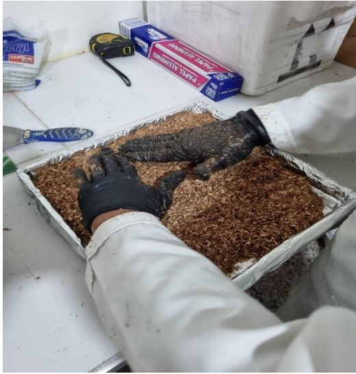
Ilustración 5; Mezcla y moldeado de material particulado
