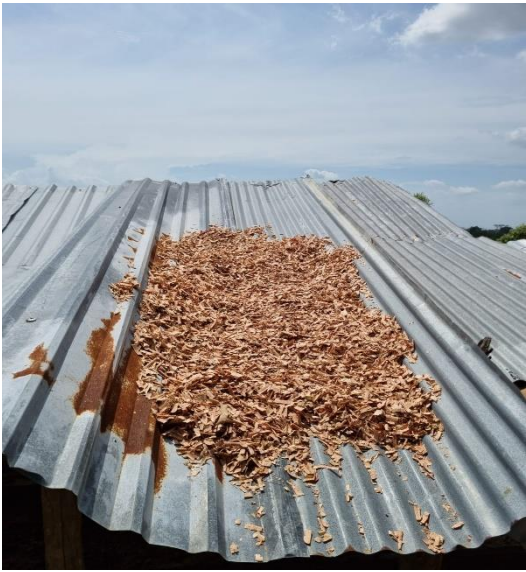
Ilustración 4; Triturado de madera y secado de material particulado
