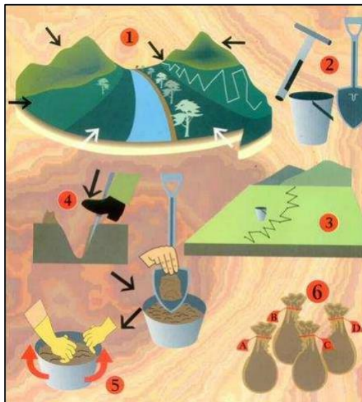
Imagen 1: Procedimiento a seguir para obtener una muestra de suelo
