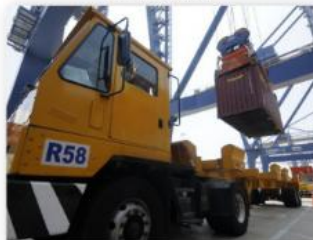
Ilustración 12. Extracción del contenedor desde el camión
